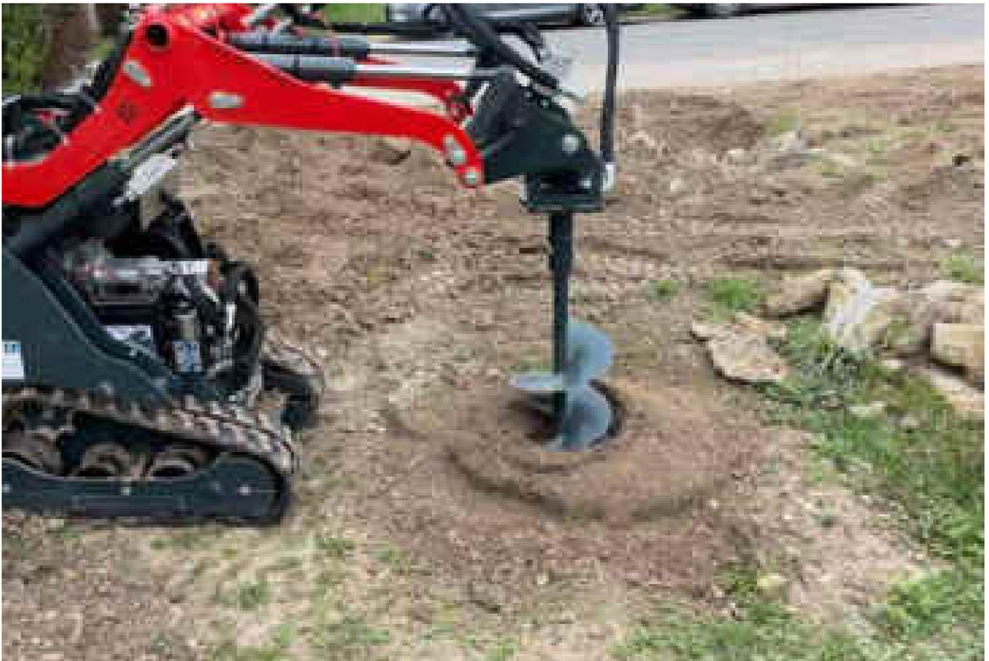
PRO Erdbohrer mit 100, 200 & 300 mm Bohrern
